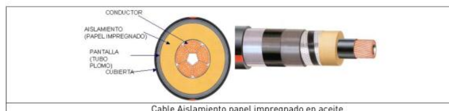
Cable Aislamiento papel impregnado en aceite
