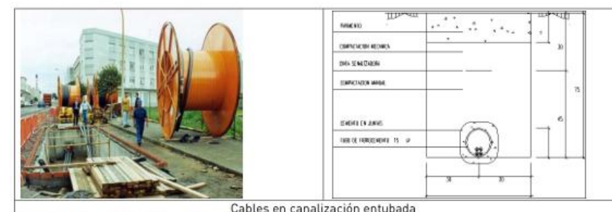
Cables en canalización entubada
